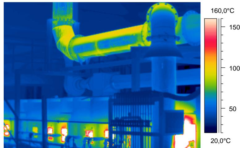
Ölschluss - Vergüteanlage für Drahtproduktion – Überprüfung der Dämmmaßnahmen
